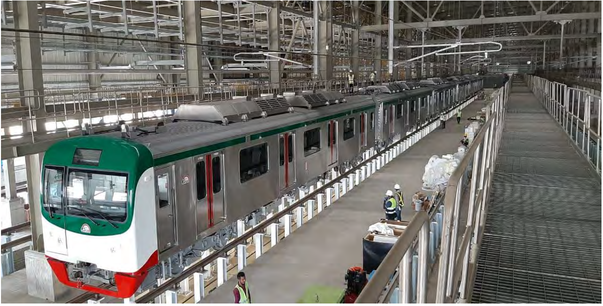
উত্তরা ডিপোর অভ্যন্তরের ওয়ার্কসপের ইন্সপেকশন লাইনের উপর বাংলাদেশের প্রথম মেট্রো ট্রেন সেট
